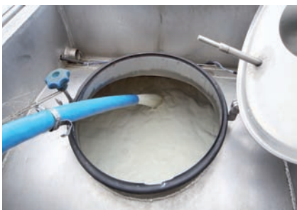
Obr. 4 Pri meraní prietoku mlieka treba pamätať na to, že sú v ňom obsiahnuté bublinky vzduchu – Promass Q je na toto meranie vhodným riešením. (© by Endress+Hauser)
