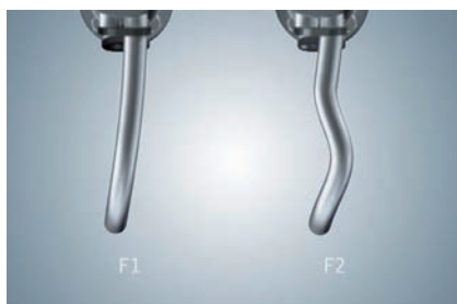
Obr. 2 Metóda MFT je založená na princípe budenia dvoch rovnakých trubíc rôznymi frekvenciami kmitov a analýzy ich správania. (© by Endress+Hauser)
